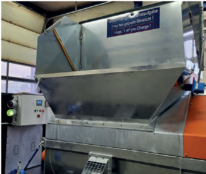
Aufgabetrichter – Spritzbleche für Transport abgeklappt
