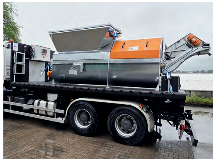
Recyclinganlage verladen auf Abroll-Lkw
