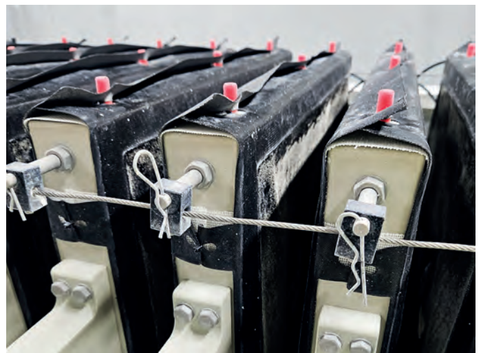
Filterplatten mit Filtertuch – Plattenpaket geöffnet
