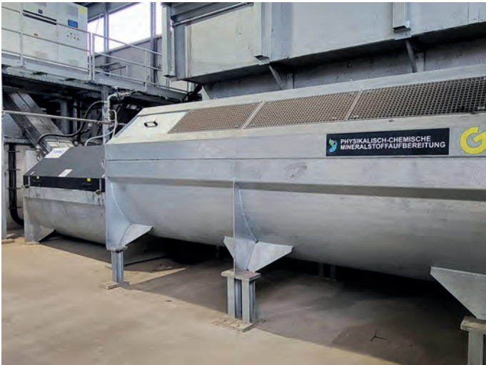
Dosierpuffer (rechts) mit Recyclinganlage (links)
