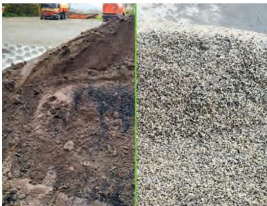
Baubrutt (links) wird Ersatzbaustoff (rechts)
