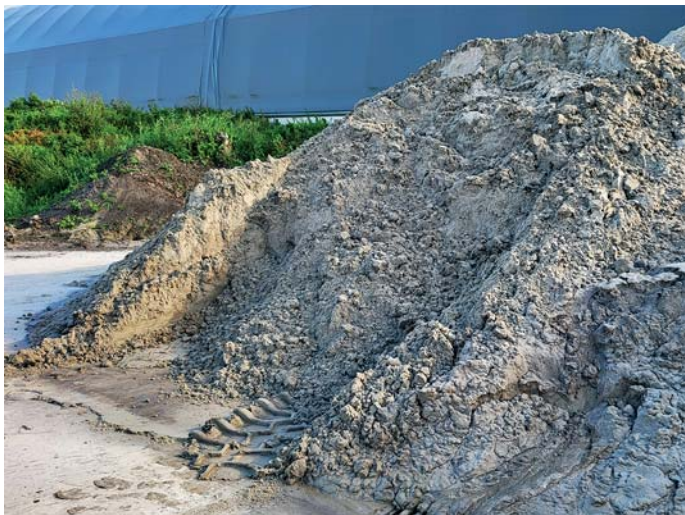
Recyclingbaustoff aus Bohrspülung
