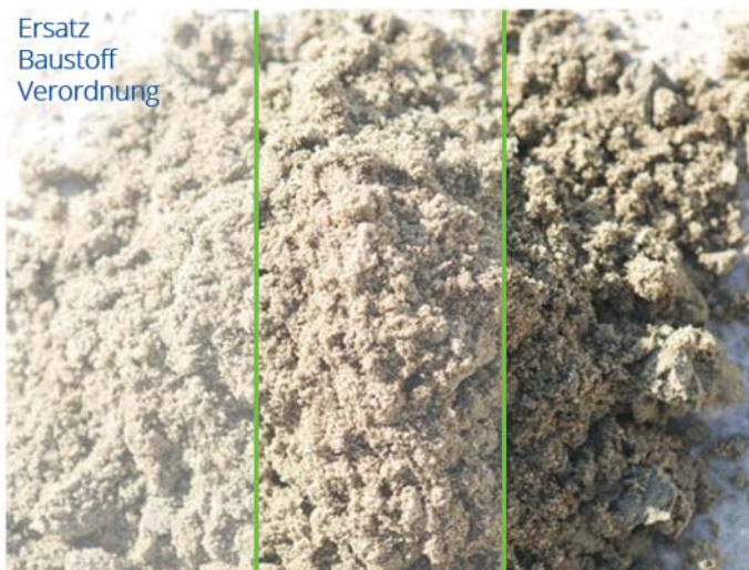
Sandfraktion aus recyceltem Kanalspülgut
