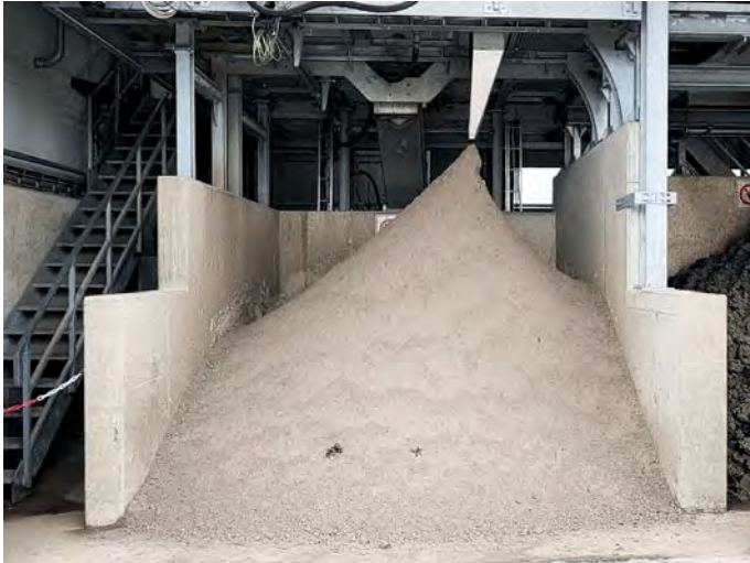
Mineralien >63 \mu\text{m} – eignungsgeprüfter Baustoff
