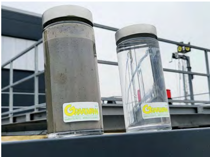
Bohrspülung (Input) | Zentrat (Output)
