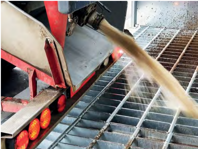
Entleerung von Bohrspülung aus Silofahrzeug
