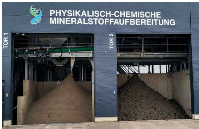
Mineralien >63 \mu\text{m} (links) | Feststoff \leq 63 \mu\text{m} (rechts)
