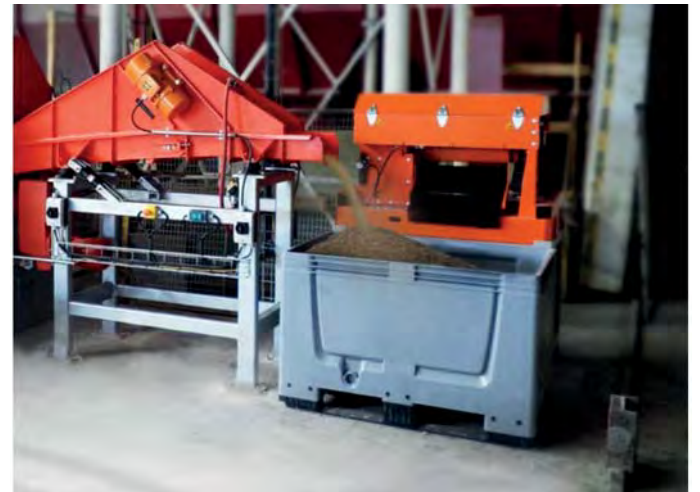
Materialaustrag mit Vibrationsrinne
