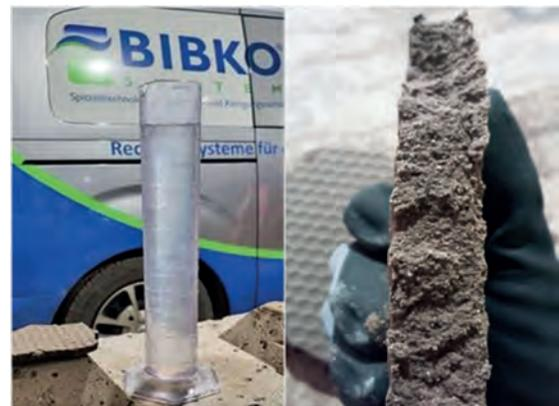
Filtrat/Filterkuchen nach Filtration mit Filterpresse
