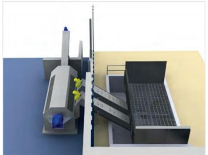
Schema: Aufgabebunker mit Recyclinganlage
