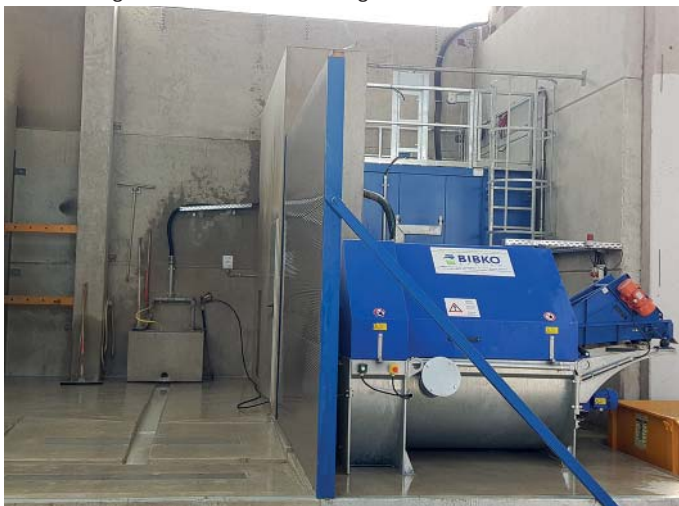
Kompakt-Recyclingsystem IT-1500/1_BW Trichter: bodeneben
