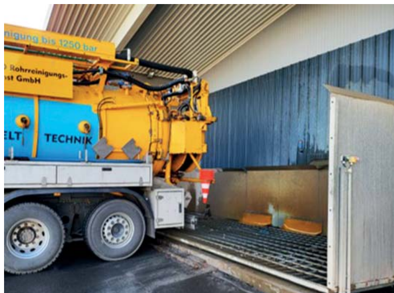
Kanalreinigungsfahrzeug – Entleerung an Recyclinganlage
