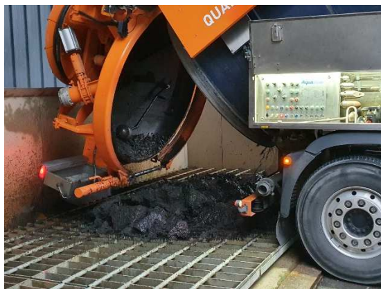
Entleervorgang Saug-/ Spülfahrzeug
